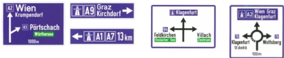
高速道路進入案内標識
